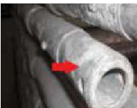
Lukitusklipsien lommot ja puuttuminen
