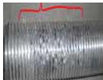
Lommot putken kierteessä
