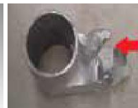
Tarkista jalkaputken kiinnityskuula ja jalkojen säädin
